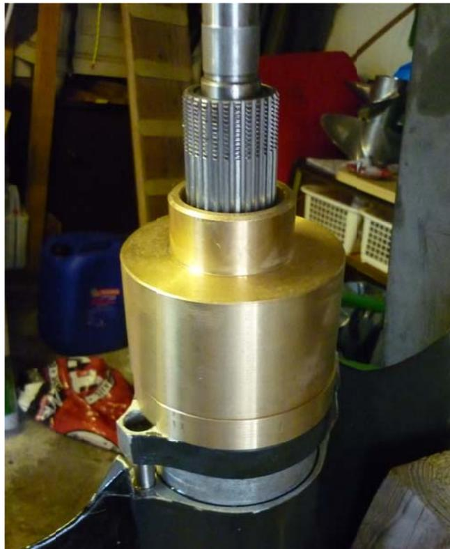
und die Einschlaghülse drauf, dann kommt das Rohr drüber und kräftig Permatex oder Hylomar auf den O-Ring – dann kann man das Lager langsam hineinschlagen
