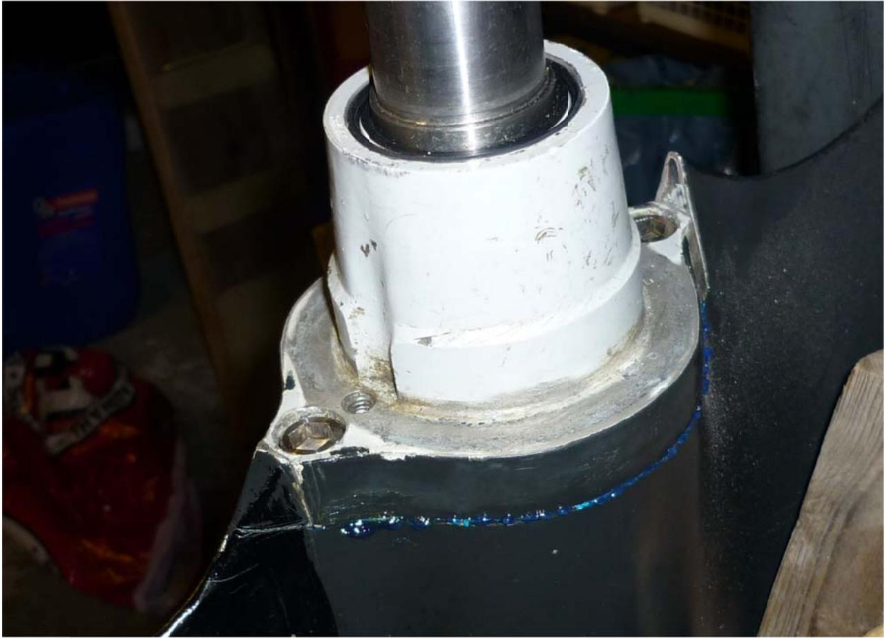
die Schrauben einsetzen und mit 40 Nm anziehen, so dass die restliche Dichtungsmasse herausgedrückt wird.
