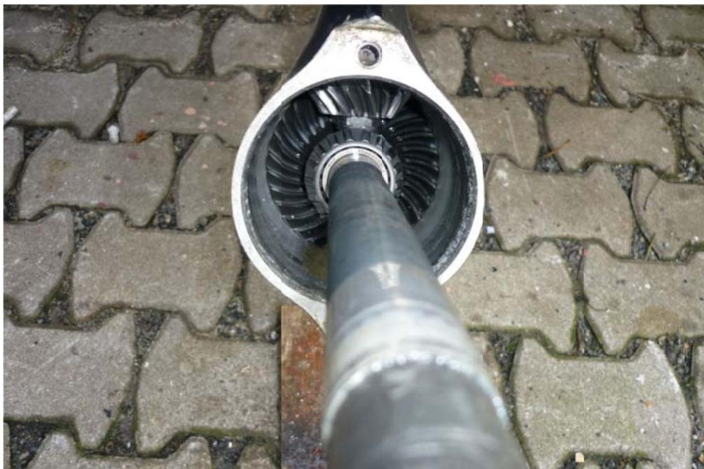
die Welle mit den Zahnrädern kann man einfach entnehmen- an der geteilten Welle und am Gehäuse müssen dann jeweils die beiden Simmerringe aus dem Doppellager entfernen und neue Dichtungen eingepresst werden –
